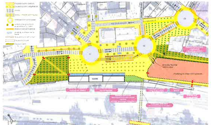
Zoom sur le franchissement de la voie ferrée par des liaisons piétonnes
