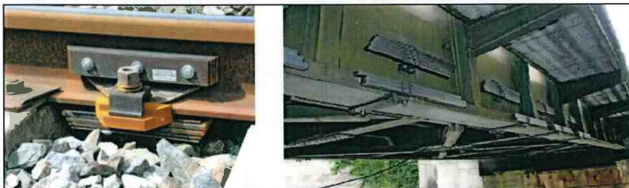
Exemples d'absorbeurs sur rail
