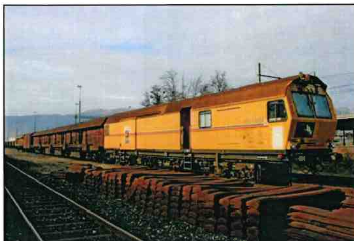
Train meuleur de rails (Scheuchzer S.A.)
